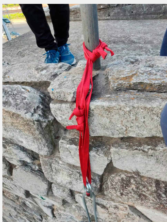
Boca de lobo
